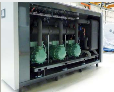
Эффективная установка теплонасосов на упругие опоры
