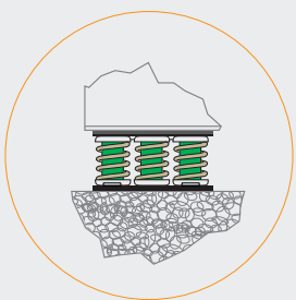
Блочная ТЭЦ Виброизолятор Isotop® BL 6 DSD
