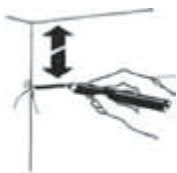
1.) Отметить высоту потолка
