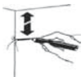
1.) Отметить высоту потолка
