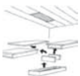
7.) Монтаж встроенных светильников
