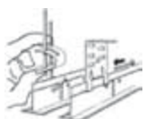
4.) Подвешивание и несущие профили
