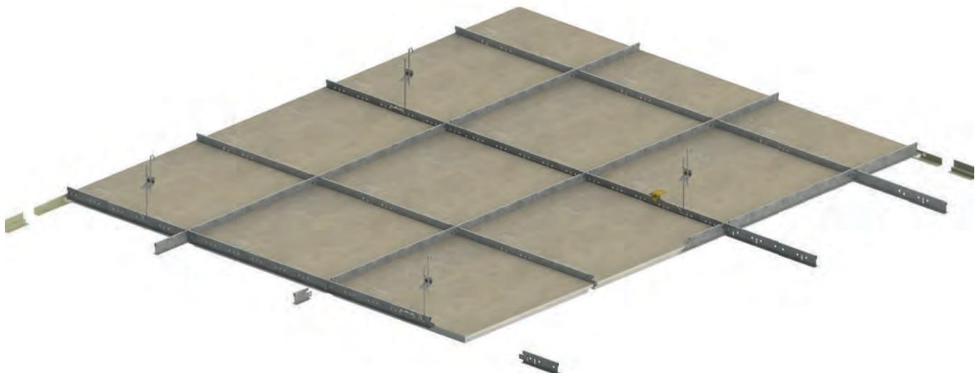
**Потолочные панели Rockfon следующих размеров с кромками A15, A24 и E24 подходят для монтажа в составе системы Rockfon System T24 A/E:**
