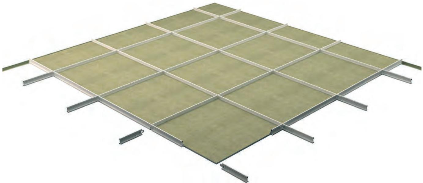
**Rockfon System Ultraline E используется для создания видимой подвесной системы толщиной направляющей 15 мм. В состав системы входит направляющая Chicago Metallic Ultraline 3500 и панели Rockfon с кромкой E.**
